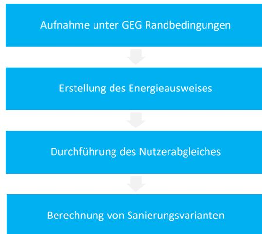
Abbildung 14: Ablauf bei der Erstellung eines Gebäudeenergieausweises
